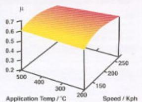
Reibbelag für Rennzwecke. Extrem hoher Reibungskoeffizient von  $\mu$  0,62. Fadingfrei bis 750 °C. Hoher Kaltreibwert. Gut kalkulierbare Bremse durch stabilen Reibwert.
