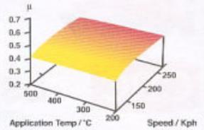
Der Belag für schnelle Strassenfahrzeuge und sportliche Fahrer. Temperaturstabil. Kein Geschwindigkeitsfading. Reibwert  $\mu$  0,42 konstant bis 650 °C.
