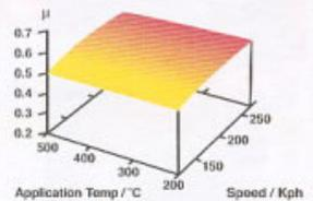
Stabiler, hoher Reibwert von  $\mu$  0,47 in allen Temperaturbereichen. Wenig Verschleiss von Belag und Scheibe. Exzellente Pedal-Rückmeldung. Der ultimative Sportbelag für die Strasse.
