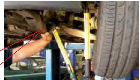
Abb.1: falscher Einbau auf Zwei-Säulen-Hebebühne (mit Tragarmen)
