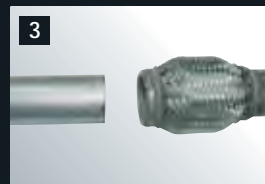
3 Altes Flexrohr entfernen.
