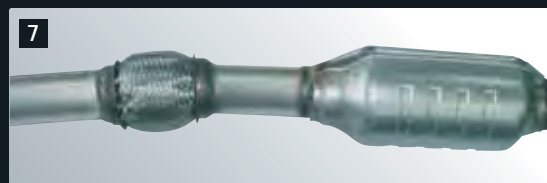
7 Clevere Reparaturlösung: Neues Flexrohr am „alten“ Bauteil.
