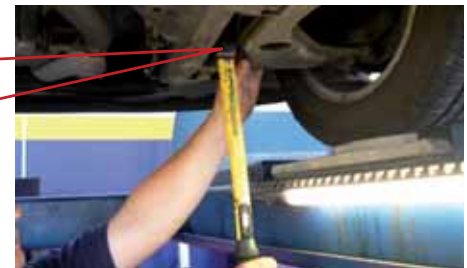
Abb.2: richtiger Einbau auf Vier-Säulen-Hebebühne (mit Fahrschienen)
